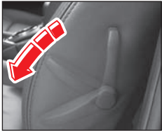
조정 레버를 위에서 아래로 내리면 허리 지지대가 운전자의 몸쪽으로 돌출되고, 위로 올리면 허리 지지대가 들어갑니다.
