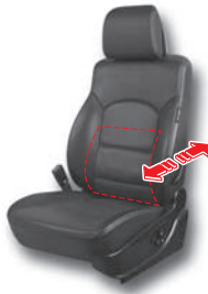
조정 레버를 위에서 아래로 내리면 허리 지지대가 운전자의 몸쪽으로 돌출되고, 위로 올리면 허리 지지대가 들어갑니다.
