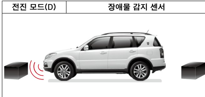
차량 전진 모드(D)에서 전방 장애물 감지 센서가 작동
