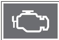
엔진의 연료 시스템이나 주요 전기장치에 이상이 발생하면 계기판의 엔진 점검 경고등이 점등됩니다. 이때 엔진 구동력이 감소하거나 엔진시동이 꺼지는 증상이 나타날 수 있습니다. 이와 같은 현상이 나타나면 당사 정비사업장에서 점검 및 정비를 받으시기 바랍니다.
