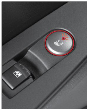
시동 스위치 ON 상태에서 스위치를 누르면 해당 시트가 따뜻해집니다. 다시 한번 누르면 시트 워머 기능이 중지됩니다. 시트 워머가 작동 중일 때에는 스위치 상단부의 작동표시등이 점등됩니다. 단, 리어 시트 등받이는 프론트 시트 히팅 기능과 달리 등받이 히팅 기능이 없습니다.
