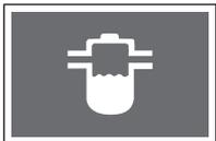
연료필터 내에 수분이 일정량 이상 적체되면 계기판의 수분 분리 경고등 점등 및 경고음이 발생하며 차량의 구동력이 감소됩니다. 이때는 즉시 연료필터 내의 수분을 제거해야 합니다. 이러한 현상이 발생하면 가까운 당사 정비사업장에서 점검 및 정비를 받으시기 바랍니다.
