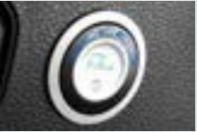
LPG 스위치 LPG 충전량 표시 및 LPG와 가솔린 전환
