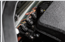
LPG 인젝터 엔진 인젝터에 LPG를 분사하는 장치
