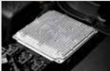
LPG ECU LPG전용 ECU로서 가솔린 ECU와 협업하여 2개 연료를 최적화
