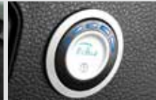
LPG 스위치 LPG 충전량 표시 및 LPG와 가솔린 전환
