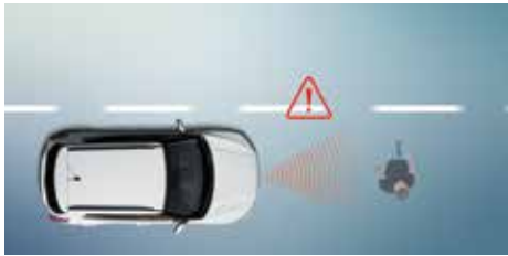
제동보조 장치 BAS (Brake Assist System) 급제동 시 브레이크의 압력을 증대시켜 제동거리를 줄이고 사고를 방지해 줍니다.
