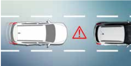
급제동 비상 경보장치 ESS (Emergency Stop Signal) 차량 급정거 시 비상등을 자동으로 점등시켜 뒷차에게 위험을 알려줍니다.
