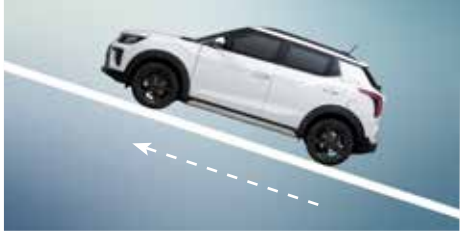
언덕 밀림 방지장치 HSA (Hill Start Assist) 언덕에서의 출발 시 브레이크에서 발을 떼어도 차가 밀리지 않도록 브레이크 압력을 일정 시간 유지시켜 줍니다.
