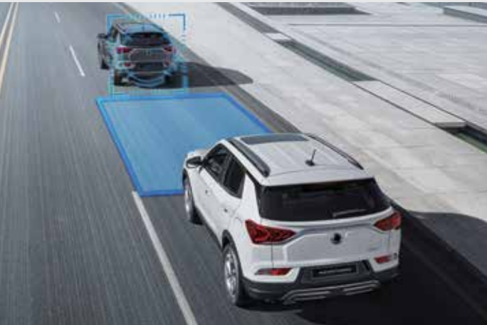
안전 거리 경고 SDW (Safety Distance Warning) 주행 중 운전차량 속도 대비 전방 차량과 안전거리 미 확보 시 경보를 통해 알려줍니다. (안전거리는 운전차량 속도에 따라 유동적으로 변동됨)
