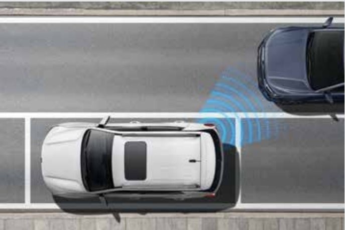
안전 하차 경고 SEW (Safety Exit Warning) 주차 후 하차할 때 후측방으로 차량이 접근 할 경우, 경고 표시 및 경고음을 통해 알려줍니다.
