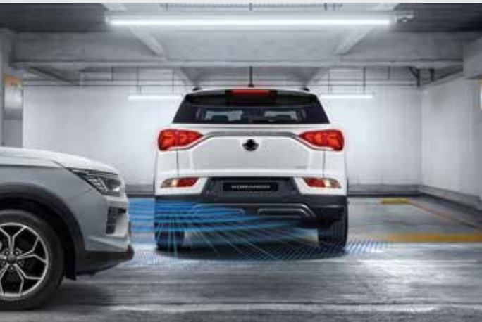
후측방 접근 충돌 보조 RCTA (Rear Cross Traffic-Collision Assist) 주차 공간이나 후측방 접근 경고 중 차량 충돌위험 예상 시 긴급 제동하여 차량을 멈춰줍니다.
