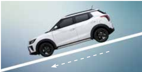
경사로 저속 주행장치 가변형 HDC (Hill Descent Control) 급경사 주행 시, 자동 저속 주행 장치가 작동되어 급가속 되지 않도록 속도를 조절해 줍니다.
