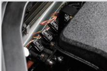
LPG 인젝터 엔진 인젝터에 LPG를 분사하는 장치
